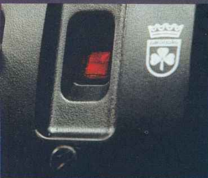
En liten fotocell anpassar hela tiden ljusstyrkan på lysdioderna till det omgivande rummets ljus.
