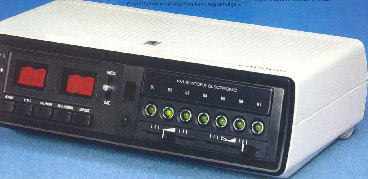
En liten fotocell anpassar hela tiden ljusstyrkan på lysdioderna till det omgivande rummets ljus.
