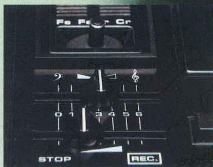
Enkel betjäning av volymkontroll med skjutreglage. Bandsortväljare för tre bandtyper. Stort instrument för batterikontroll.
